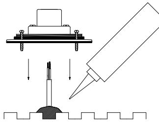
器具を取り付けた際、器具内にシール剤が出るくらい、電線の出し口に多めに塗って下さい。(器具・電線出し部の防水処理)
