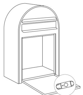
6 ダイヤル錠を取り付けたら、扉を閉めて施錠・解錠の確認をします。
