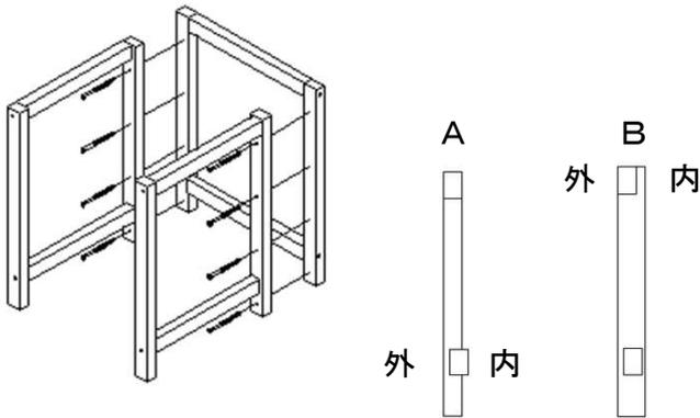
②天板を、φ3.3×40スリムネジで脚フレームA, Bに組付けます。
