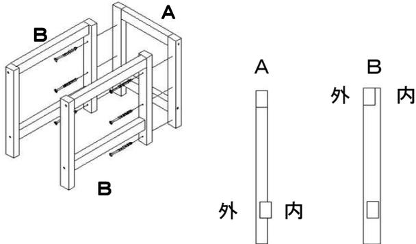
②天板を、φ3.3×40スリムネジで脚フレームBに組付けます。
