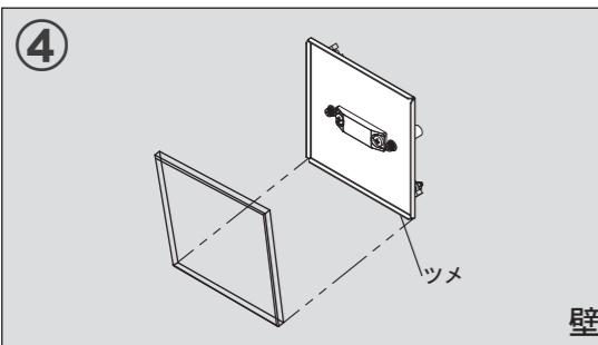
④本体手前下部にあるツメをパネルでかぶせるようにして、マグネットでしっかりとパネルを装着して完成です。
