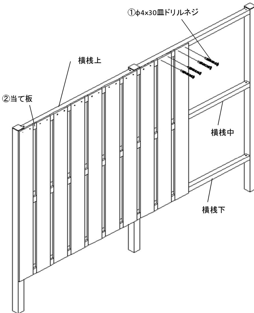
**4 板幅・柱ピッチの調整** (図の→ : 施工前の配慮が必要です。)
