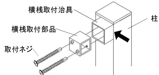
※横棧取付治具を、柱の板を貼る面側に合わせます(黒矢印)。位置がずれないようにして、φ4x25ドリルネジで横棧取付部品を取付けます。
