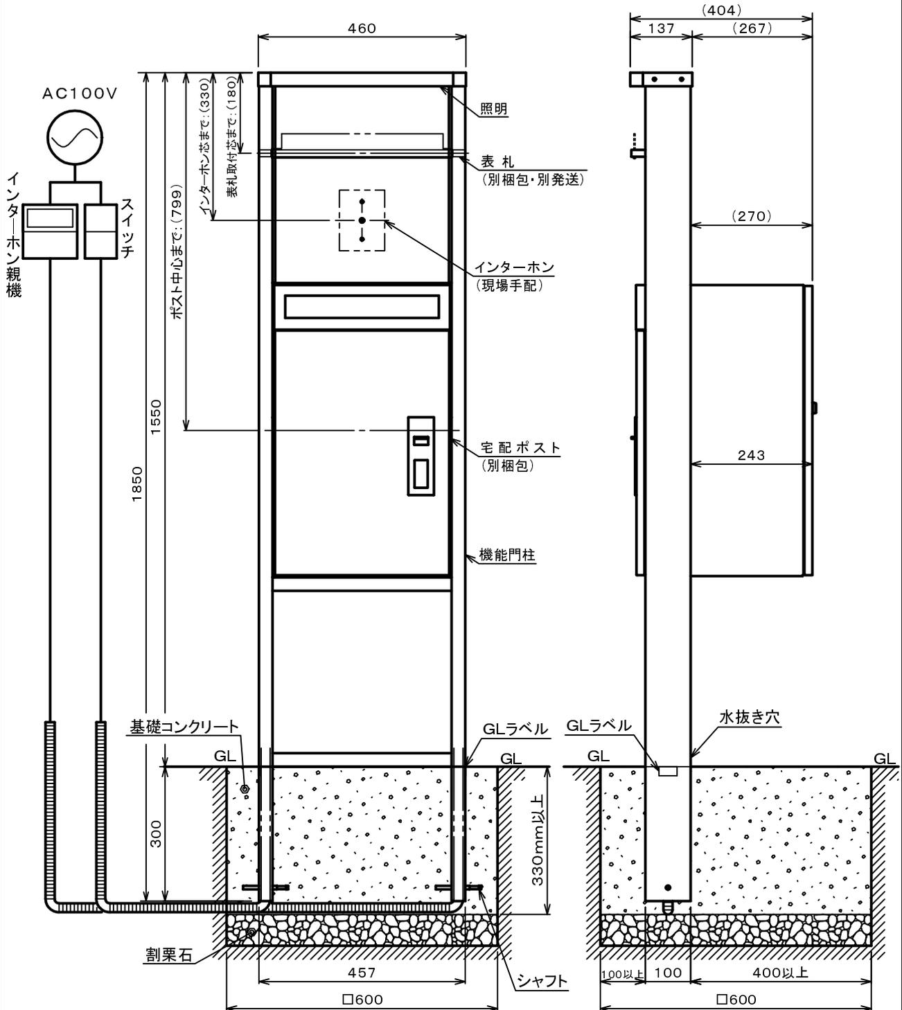
※上図の基礎の寸法は参考値です。施工現場の地盤強度によっては基礎の寸法を変更してください。
