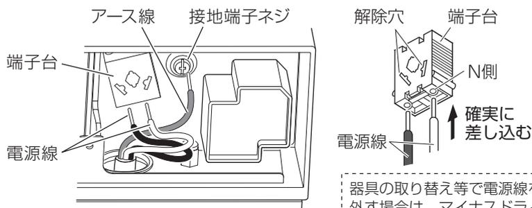
・接地端子ネジからD種(第3種)接地工事を行ってください。
