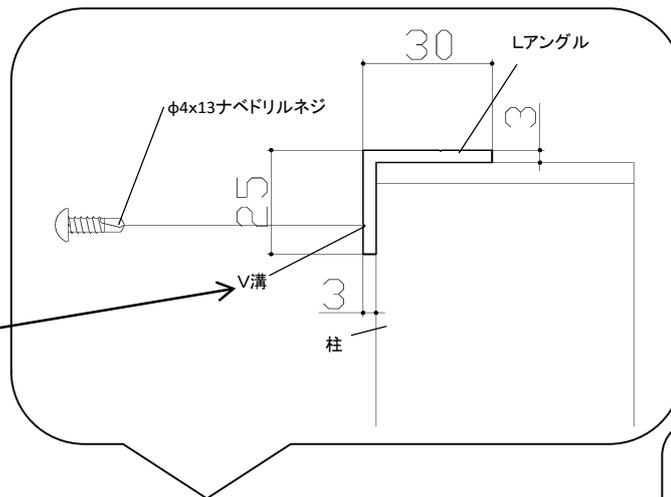
V溝の中央にネジ止めをしてください。
