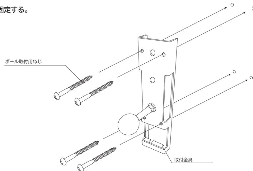
⑤ミラー本体に取り付けているロックキャップを外し、ピボットにかけ、ミラーを軽く押し込む。
