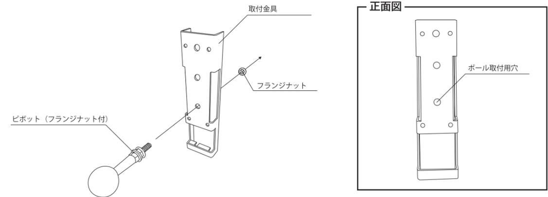
②ポール用ワッシャーとポール取付用ねじを用いて取付金具を固定する。
