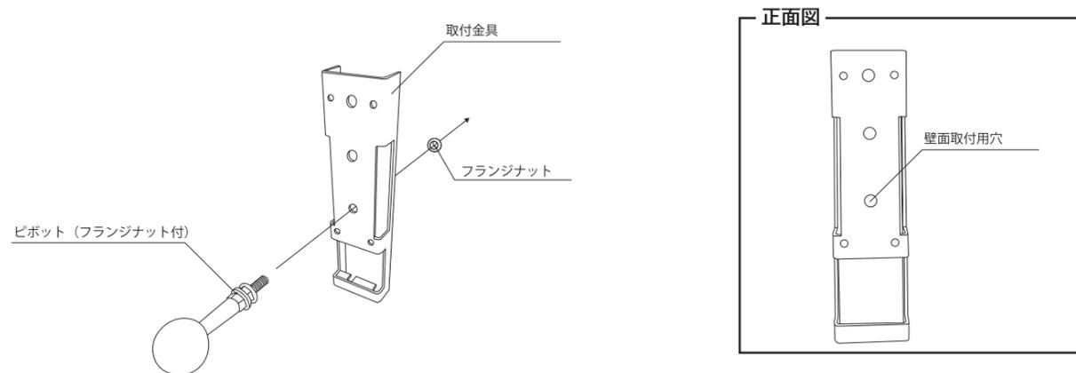
④壁面固定用木ねじを用いて取付金具を固定する。
