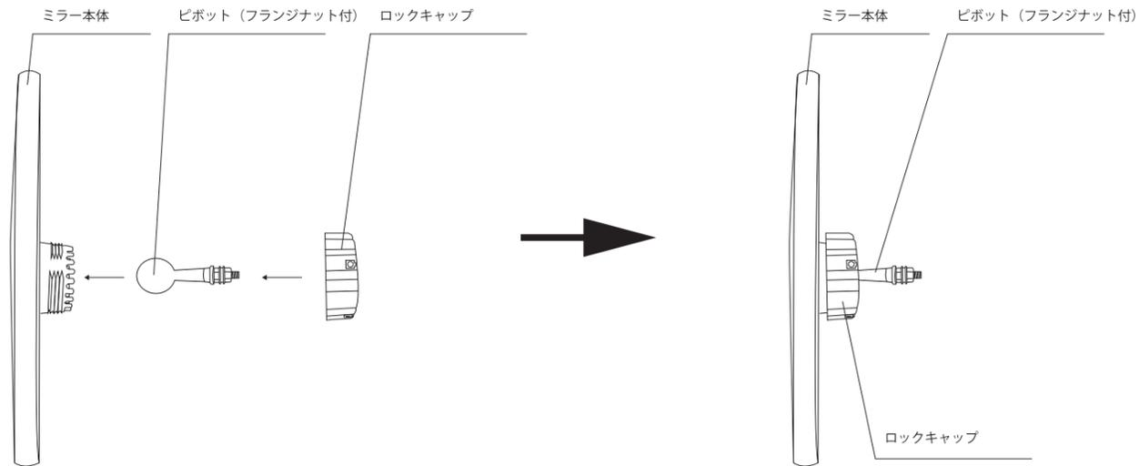
⑤ミラー本体に組み付けたピボット（フランジナット付）を取付金具の所定の位置にフランジナットを用いて固定する。
