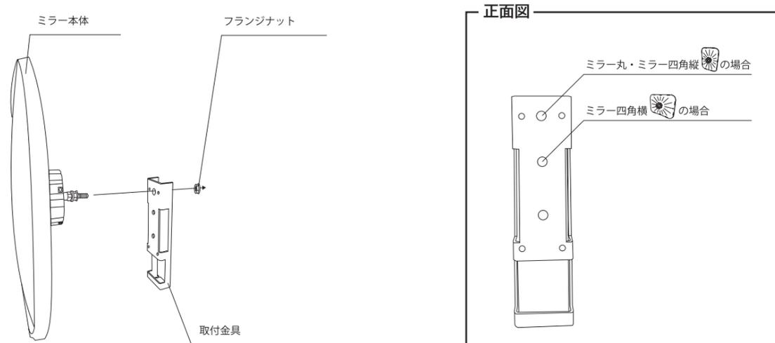
⑥ミラーの角度を調整し、角度が決定したら、ロックキャップを最後まで締め、ロックピンを入れ、固定する。
