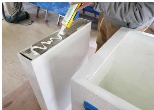
②側面ボード上部の板に接着剤を塗ります。
