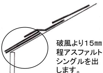
破風より15mm程アスファルトシングルを出します。
