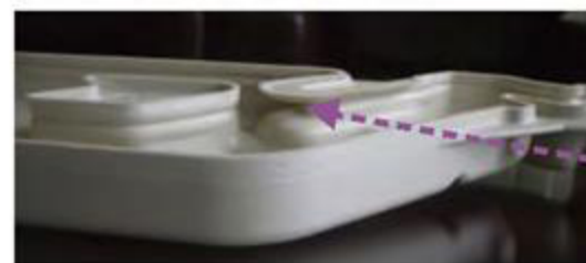
分流器を半分に切断した参考写真
