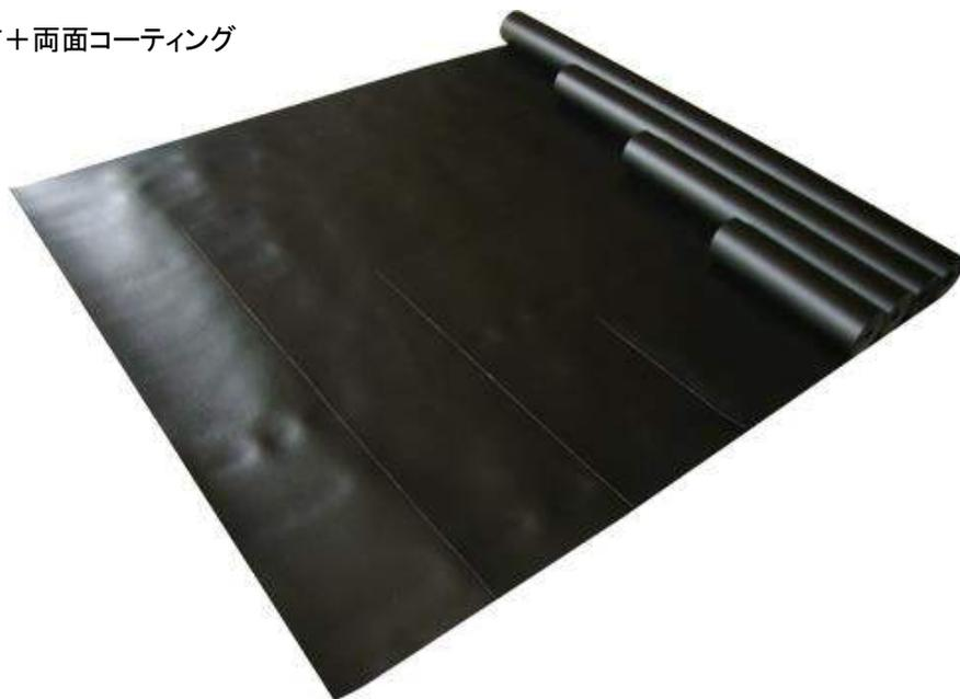
PP繊維による4層спанボンド不織布にPP樹脂を両面コーティングした根域制限資材です。100%ポリプロピレン製であるため、土中では紫外線を受けず長持ちします。加水分解しにくく、薬品・酸・アルカリ・微生物に対して影響を受けにくい素材で土中においては半永久的に効果を維持します。又、上部が露出した場合でも紫外線劣化防止加工を施しておりますので安心です。
